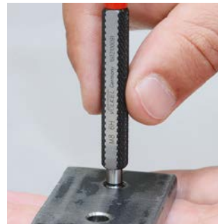
Prüfung mit Präzisions-Gewindelehrdorn Checking with Precision Thread Plug Gauge
